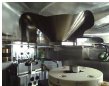
Обзорная камера внутри вакуумной камеры микроскопа, позволяет следить за положением образца во время работы
