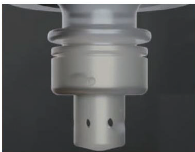
В катодном блоке при смене образца поддерживается вакуум 5 \cdot 10^{-5} Па, что значительно увеличивает срок службы вольфрамовой нити
